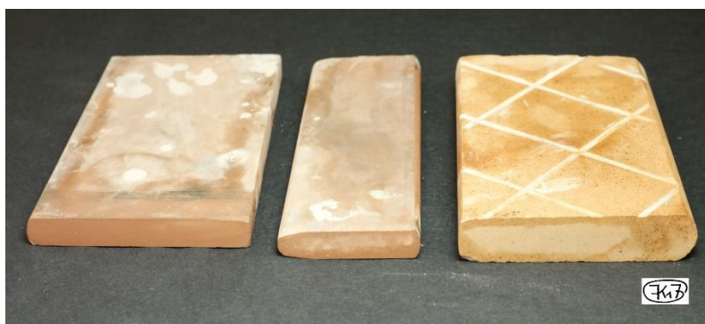
Bild 32: Formsteine zum Bearbeiten der Innenseite von Hohleisen
