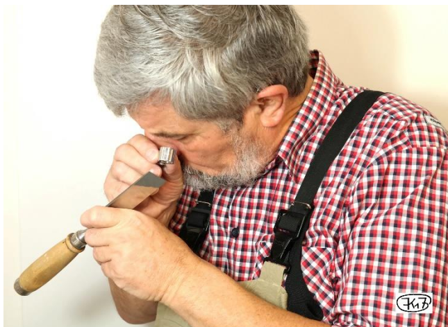
Bild 46: Benutzung einer starken Einschlaglupe bei der Kontrolle einer Schneide
