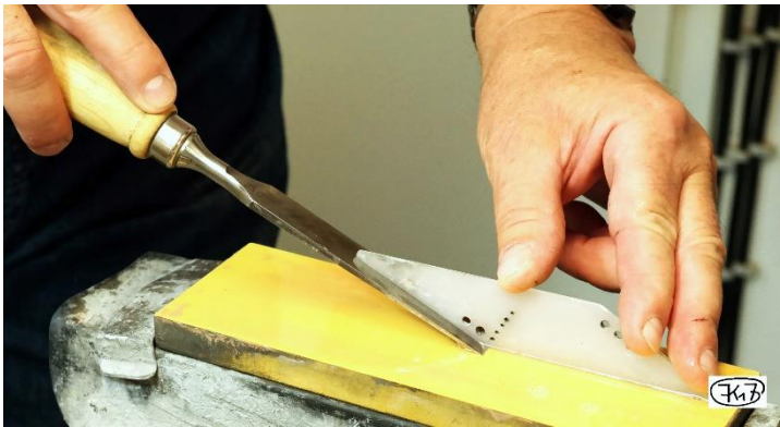
Bild 12: Ausrichten des Eisens zum Stein mit der Winkellehre und Schleifen vor-zurück
