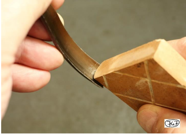
Bild 37: Entgraten an der Innenseite eines gebogenen Hohl eisens
