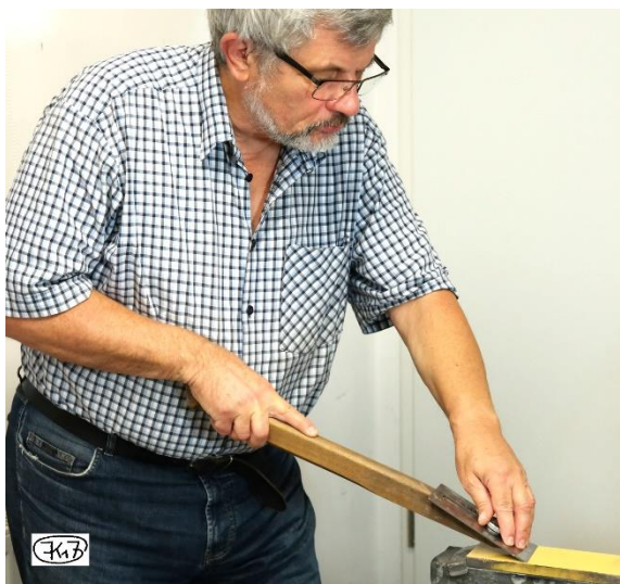
Bild 19: Schleifen eines Hobeisens mit einem Halter
