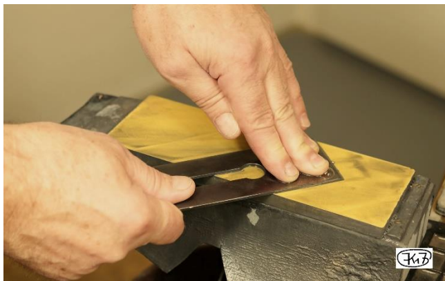
Bild 25: Schleifen der Spiegelseite eines Hobeisens auf dem Bankstein
