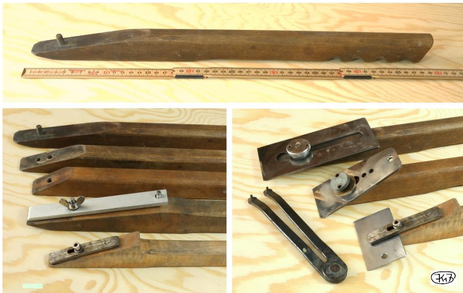
Bild 44: Halter für Hobeisen oben: 10°- Halter unten links: Halter mit 10°, 20° und 30° sowie zwei Halter für Eisen ohne Loch unten rechts: Halter mit aufgespannten Eisen sowie Stirnlochschlüssel
