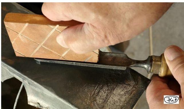
Bild 34: Grat entfernen an der Innenseite eines geraden Hohleisens
