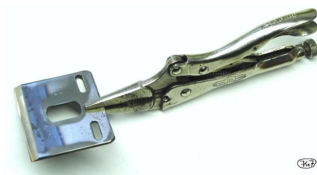
Bild 45: Schabhobeisen, mit Gripzange gehalten
