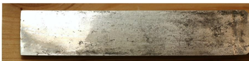
Bild 27: Planschleifen einer Spiegelseite
