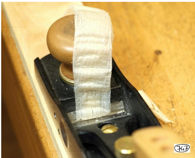
Bild 57: Span am Putzhobel, dessen Eisen eine bogenförmige Schneide hat
